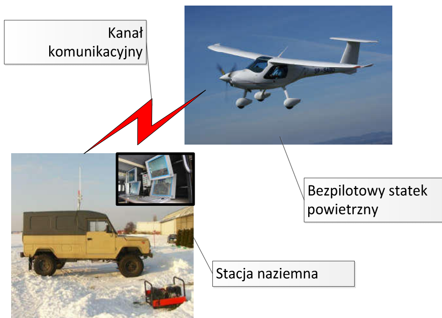
Rys. 1. Podstawowe składniki systemu bezpilotowego statku powietrznego
