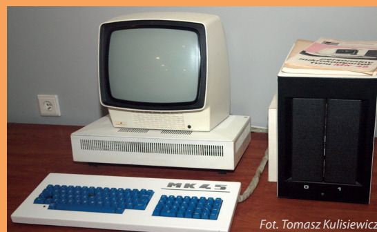
Komputer MK 45 ze stacją dysków 8-calowych produkowany od 1984 r. w MERA-KFAP w Krakowie.
