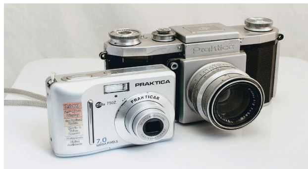
Po lewej: cyfrowa Praktica DPix 750Z: obiektyw Prakticar 2,8–5,2/6,2–18,6 mm, przetwornik CCD 1/2,5" o rozdzielczości 7,21 Mpx. Produkowany na Dalekim Wschodzie w latach 2008–2010 dla „spadkobiercy” eneradowskiego koncernu VEB Pentacon – firmy Pentacon GmbH Foto – und Feinwerktechnik Dresden. Po prawej: pierwszy aparat, który nosił nazwę Praktica, produkcji VEB Mechanik Kamera-Werkstätten Niedersiedlitz z 1949 r.
