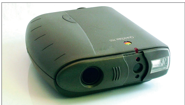
Apple QuickTake 150 z 1995 r. produkowany dla Apple przez Kodaka. Nie miał pamięci zewnętrznej, w 1 MB pamięci Flash EPROM mieściło się 16 zdjęć formatu 640 x 480 lub 32 zdjęcia 320 x 240
