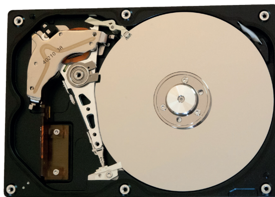
Wnętrze napędu HDD, widać talerz magnetyczny i głowicę na ramieniu.
