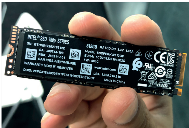
Intel 512 SSD w formacie M.2 przyjmuje postać wąskiej płytki, niekiedy obudowanej radiatorem odprowadzającym ciepło.
