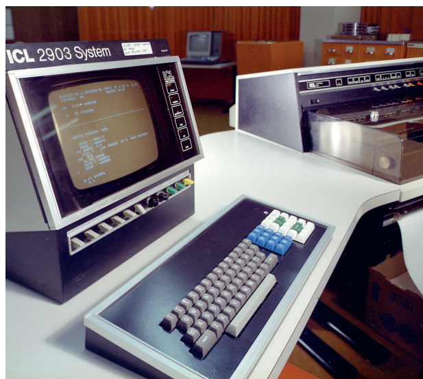
ICL 2903 – konsola operatorska i wbudowana drukarka
